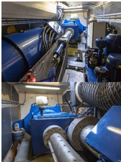
Brendësia e nacelës së turbinës me erë përfshin boshtin, kutinë e shpejtësisë, mekanizmin e bashkimit dhe sistemin e ftohjes.
