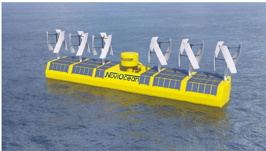
Termocentral hibrid që përdor energjinë e valëve, të erës dhe të diellit. I ashtuquajtur Konvertues Hibrid i Energjisë (HEC)
