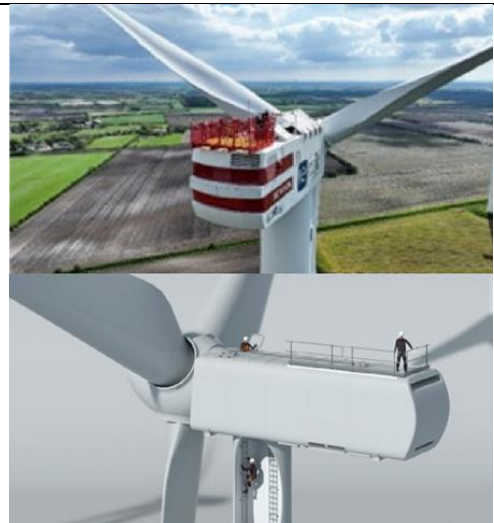
Shembull i një barriere sigurie të montuar direkt në majë të nacelës
